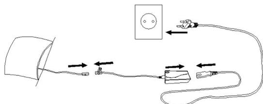
Assurez-vous si les informations sur le raccordement électrique indiquées sur la plaque signalétique sont cohérentes avec les paramètres du système d'alimentation. Si ce n'est pas le cas, contactez un électricien.
